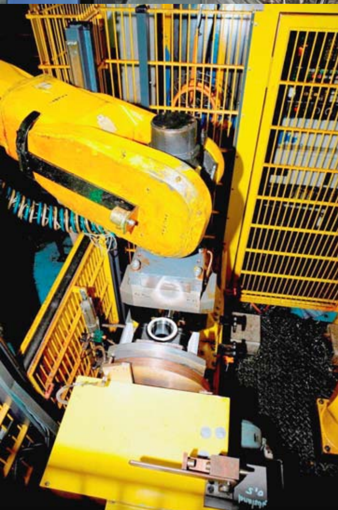
Roboterzelle zum Be-, und Entladen eines Bohrzentrums und einer Wirbelstromprüfzelle für Achsschenkel
