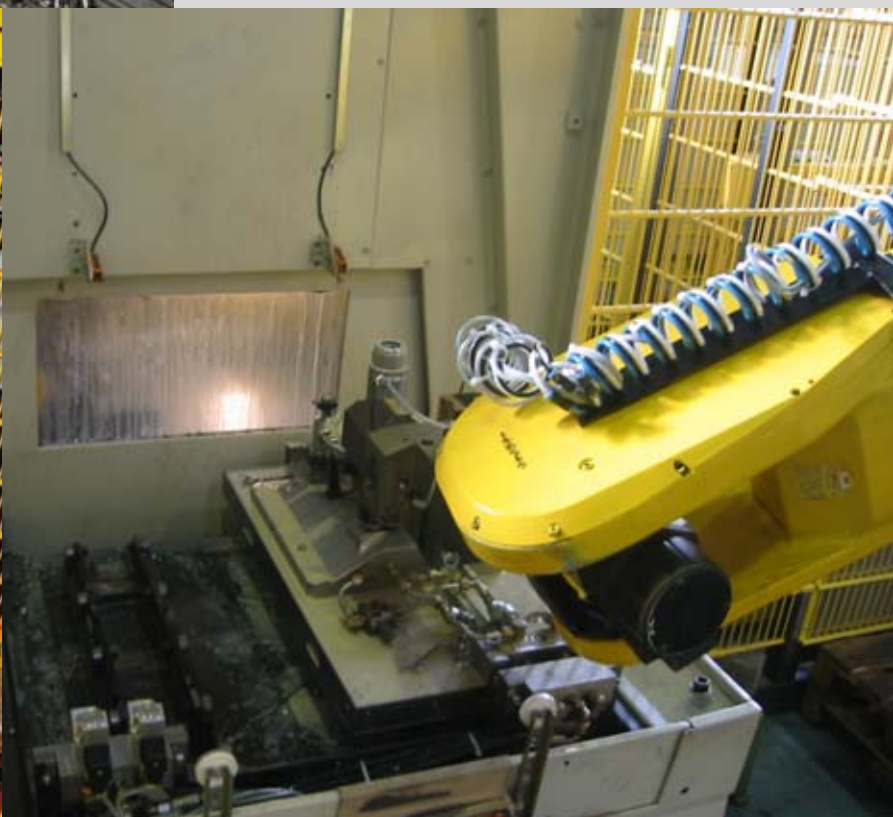
Doppelzelle in Linie verkettet mit manueller Zuführung und je einem gebrauchten FANUC Roboter zur Bearbeitung von Stahlschmiedeteilen
