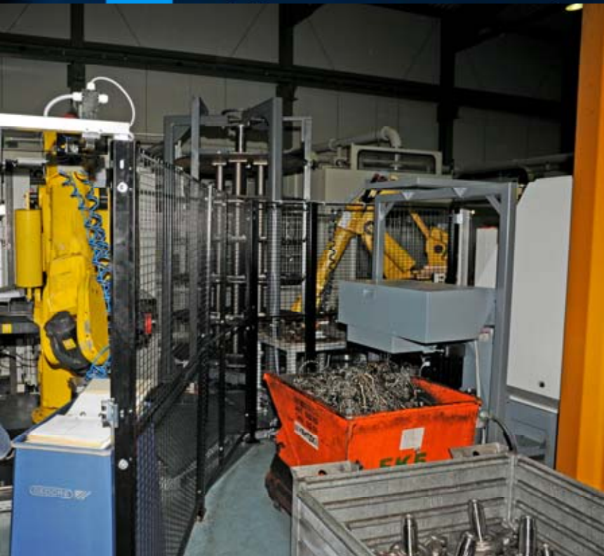
Doppelzelle in Linie verkettet mit manueller Zuführung und je einem gebrauchten FANUC Roboter zur Bearbeitung von Stahlschmiedeteilen
