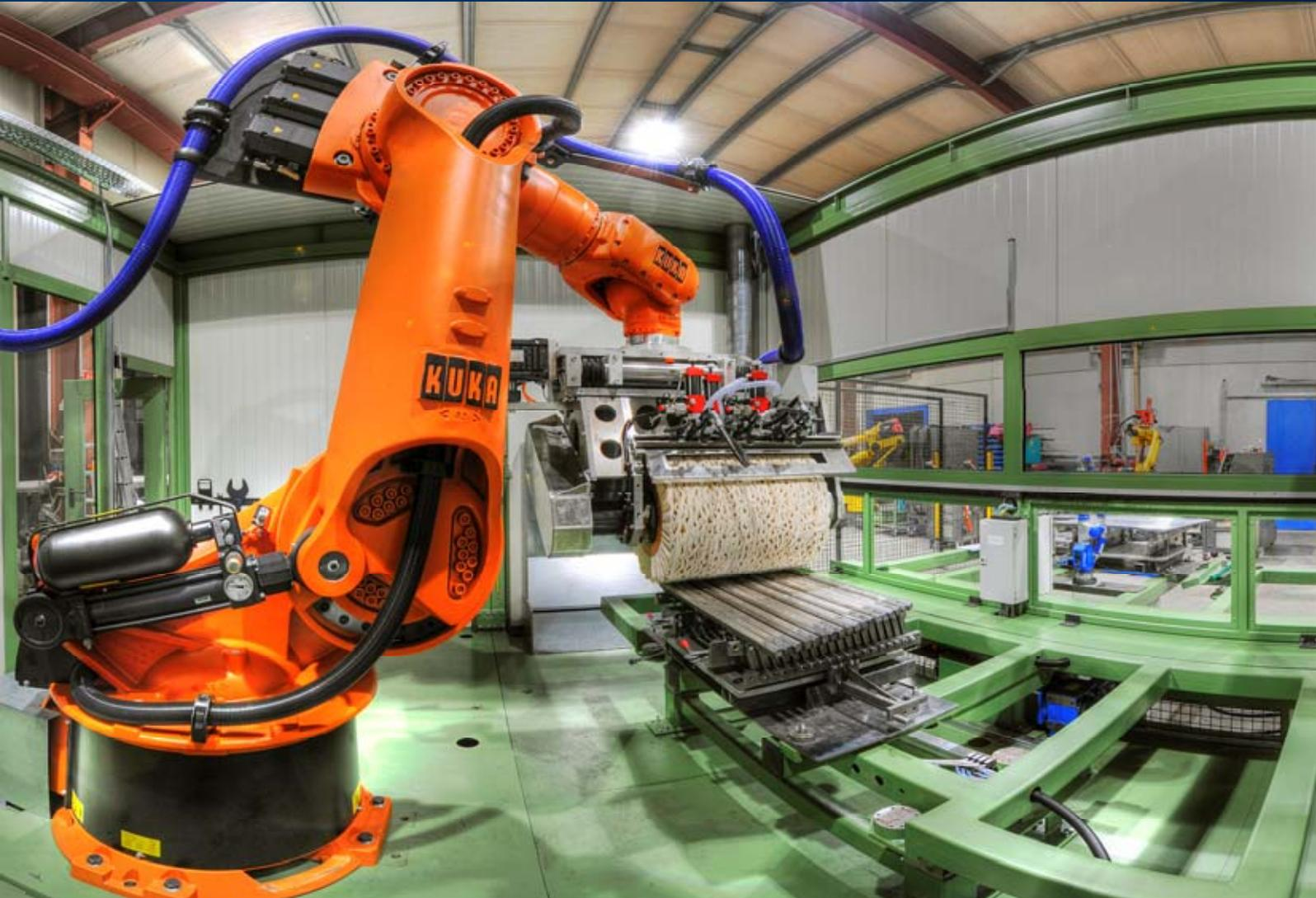
Das **werkzeugführende Bearbeitungssystem ROBOCELL 400** wurde in enger Zusammenarbeit mit unseren Kunden als Antwort auf die immer weiter steigenden Anforderungen beim Polieren, Bürsten oder Schleifen von liegenden Werkstücken weiterentwickelt. Für Werkstücke, die aufgrund ihrer Größe oder Form nicht werkstückgeführt bearbeitet werden bietet dieses einzigartige und hochflexible Bearbeitungssystem genau die passende Lösung.
