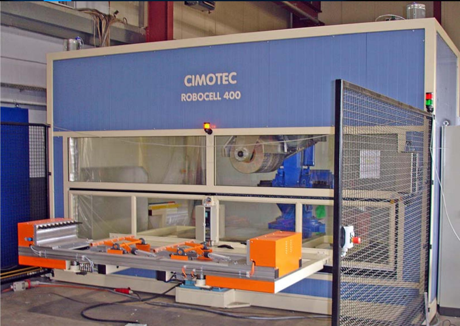
Die **werkzeuggeführte** Baureihe **ROBOCELL 400** hat durch konsequente Weiterentwicklung das moderne Polieren, Bürsten und Schleifen von langen und großen Werkstücken neu definiert. **Neue Bearbeitungseinheiten** ermöglichen ein **wirtschaftliches, flexibles und rationelles Arbeiten** bei langen, großen oder sperrigen Werkstücken, die mit werkstückgeführten Systemen nur sehr schwierig oder gar nicht bearbeitet werden können.
