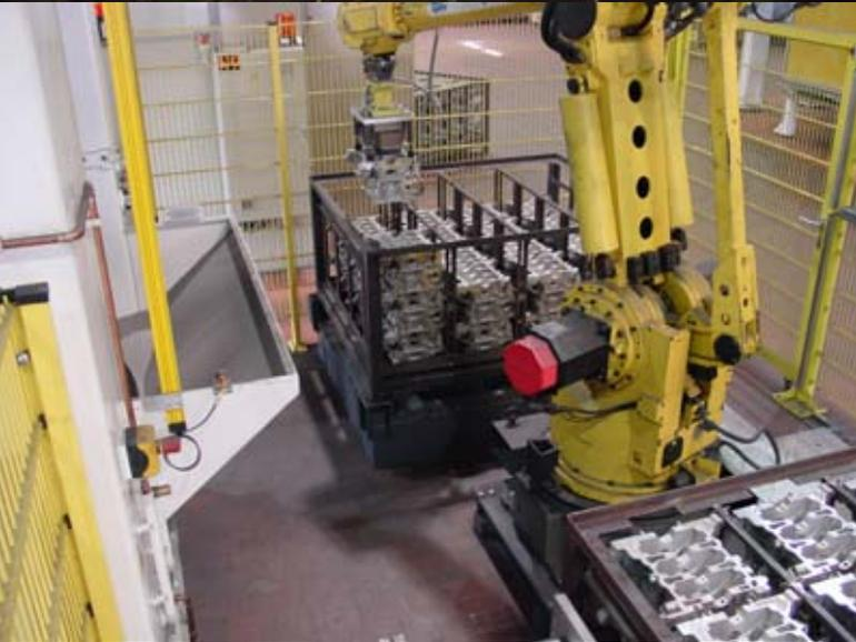
Der Roboter entnimmt Motorblöcke aus einer Stahlpalette, hängt diesen auf eine Aufnahme in einer Strahlkammer, und verpackt die Motorblöcke nach Entnahme aus der Maschine abschließend in eine Transportpalette. Die Bereitstellung der Leer- und Vollpaletten wird durch den Bediener manuell durchgeführt. Hierzu sind entsprechende Tore mit Bedienfeld in den Schutzzaun integriert.
