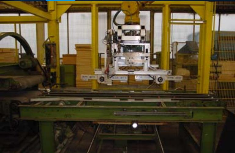
Palettierzelle mit Doppelgreifer zum Aufstapeln von Systemplatten aus der Raumgestaltungstechnik. Bodenplatten werden vom Zwischenförderer paarweise aufgenommen und vom Roboter aufgestapelt. Die Zelle ist direkt an die Auslaufbänder der Fertigungsstrasse montiert, und im Schutzzaunverbund der Gesamtanlage integriert.
